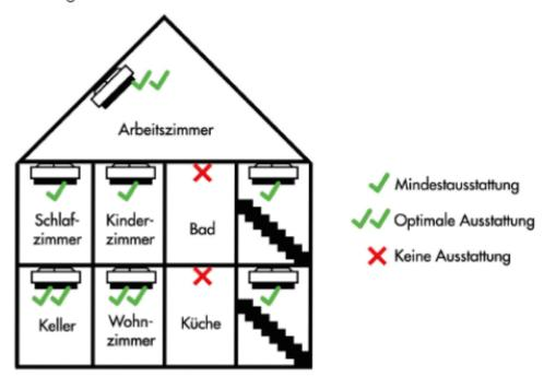
Ist Ihre Decke durch Holzbalken o.ä. in Deckenfelder unterteilt, gilt folgendes: Ist die Unterteilung höher als 20cm und sind Deckenfelder insgesamt größer als 36 Quadratmeter, dann sollte je Deckenfeld ein Rauchmelder installiert werden. Bei Dachschrägen ist der Rauchmelder auf einer der Dachschrägen und nicht im Giebel zu installieren. Hinweis: Beachten Sie unbedingt bei der Planung der Ausstattung auch die Vorschriften der Landesbauordnung in Ihrem Bundesland.
